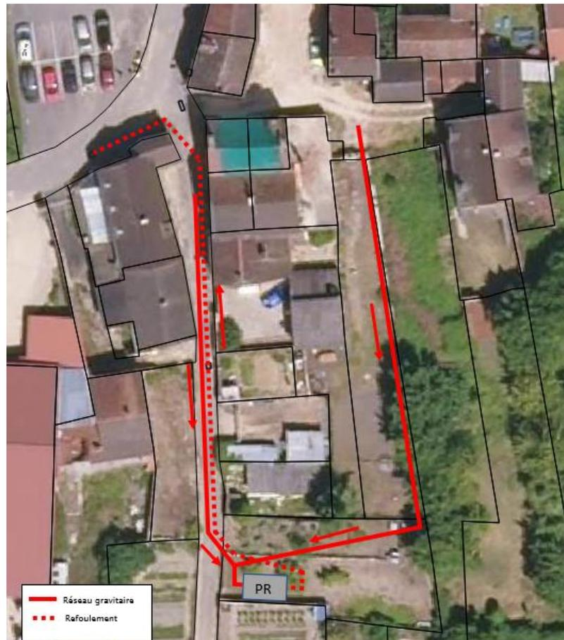
Figure 22: Descriptif des travaux de raccordement rue du Gué
